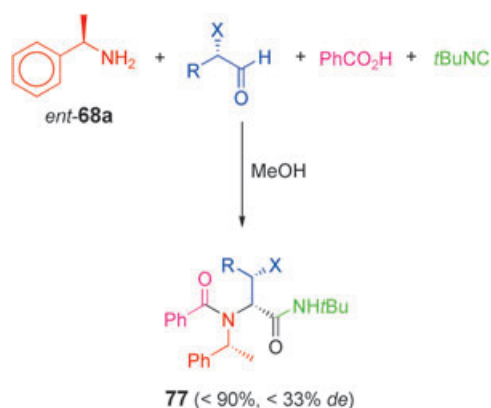
Schema 35. Diastereoselektive Ugi-Vierkomponenten-Reaktion mit einem chiralen Amin und einem chiralen Aldehyd.
