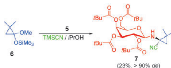
Schema 3. Die in der Synthese von Methanovalin verwendete diastereoselektive Strecker-MCR.
