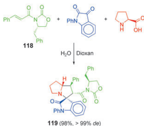
Schema 56. Diastereoselektive 1,3-dipolare MCR mit einem chiralen Dipolarophil.
